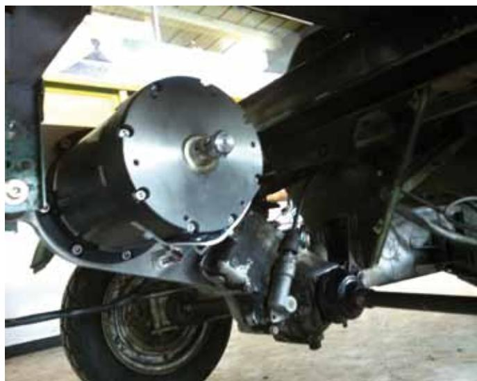
Die Drehstromasynchronmaschine an Ort und Stelle
