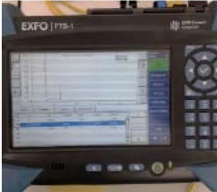
OTDR-Messgerät mit Anzeige des Dämpfungsverlaufs einer Glasfaser-Strecke
