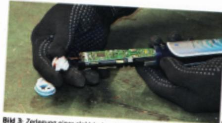
Bild 3: Zerlegung einer elektrischen Zahnbürste
